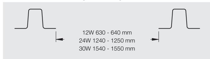
Per la perfetta posa in opera degli apparecchi, occorre posizionare i profili portanti alle quote sopra indicate (luce netta fra i profili).
